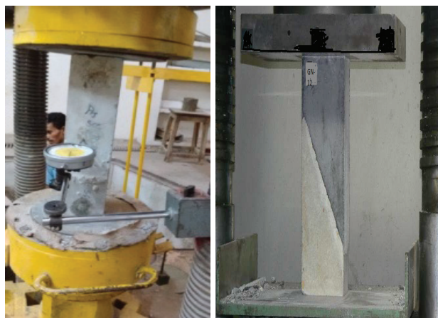
Rys. 4. Badanie belek poddawanych ściskaniu
