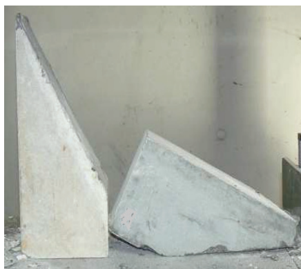
Rys. 8. Zerwanie przyczepności w zespolonej belce
